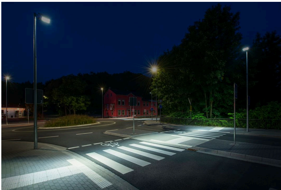
Рисунок 1.21 – Оборудование пешеходного перехода в жилой зоне осветительными приборами с асимметричным светораспределением
