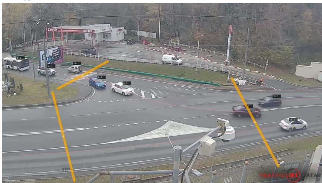
Рисунок 5.3 - Пример обработки видеосигнала поступающей со стационарной камеры в программе TrafficData
